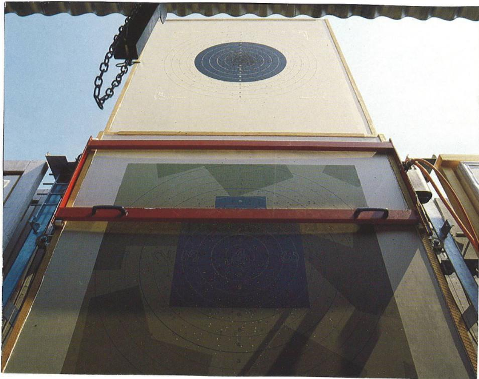
Das Scheibenwechselsystem ist am Scheibenwagen des Scheibenzuges angebracht. Beim Einschalten der Anlagen wird automatisch die "A"-Scheibe aufgezogen.
