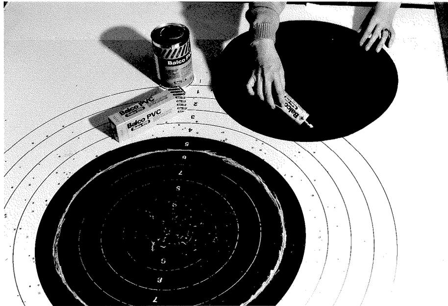
13. Den PVC-Kleber (1,3) innerhalb der auf dem Deckbild markierten Fläche dünn auftragen.
